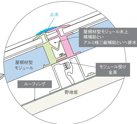
アルミ棧 モジュールの止水構造
